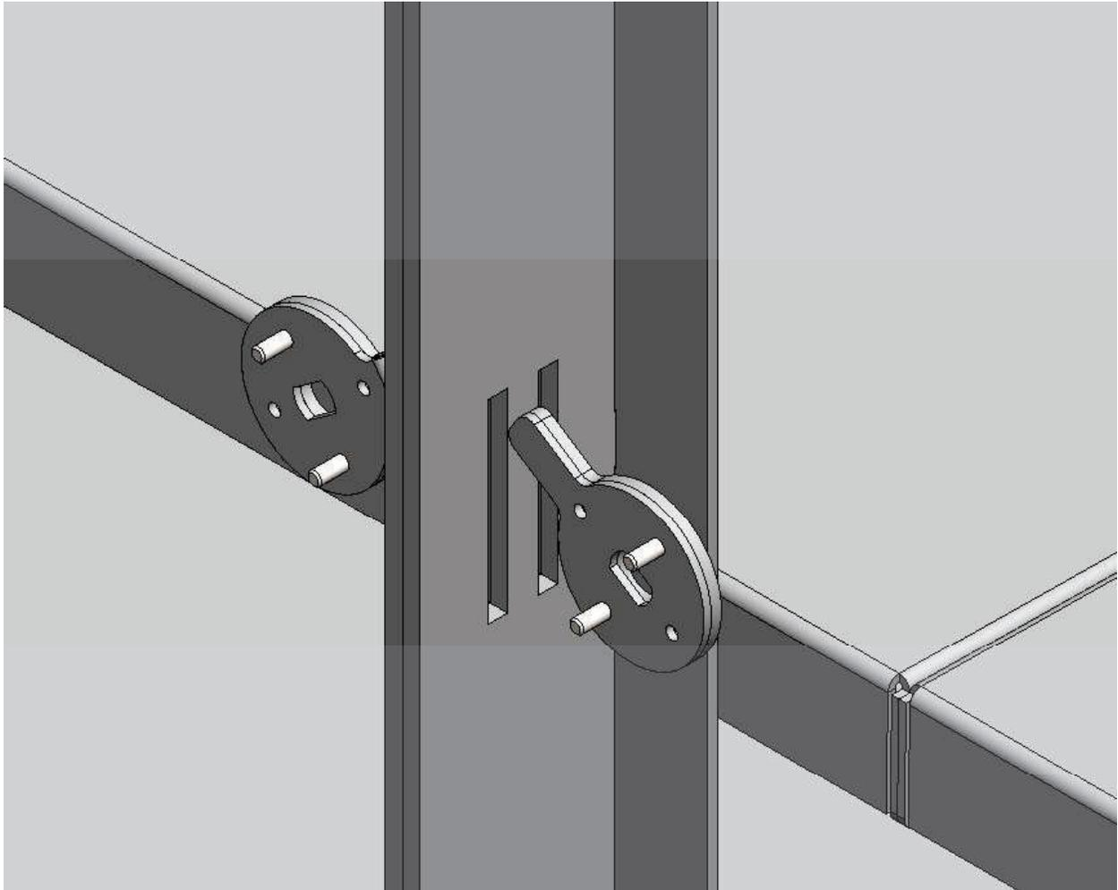
Puedes aflojar los dos tornillos en la parte superior y los dos tornillos en la parte inferior para el parteluz, de ahí, se puede ajustar la pieza deslizándose hacia atrás o hacia adelante para calzar con los candados, luego, apriete de nuevo los tornillos para asegurar el parteluz en la nueva posición.
