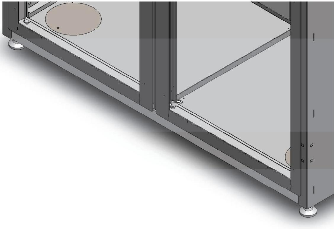
Para atrás, necesitaras remover la placa circular adentro, ajustar los pies, y colocar de nuevo las placas circulares al terminar.
